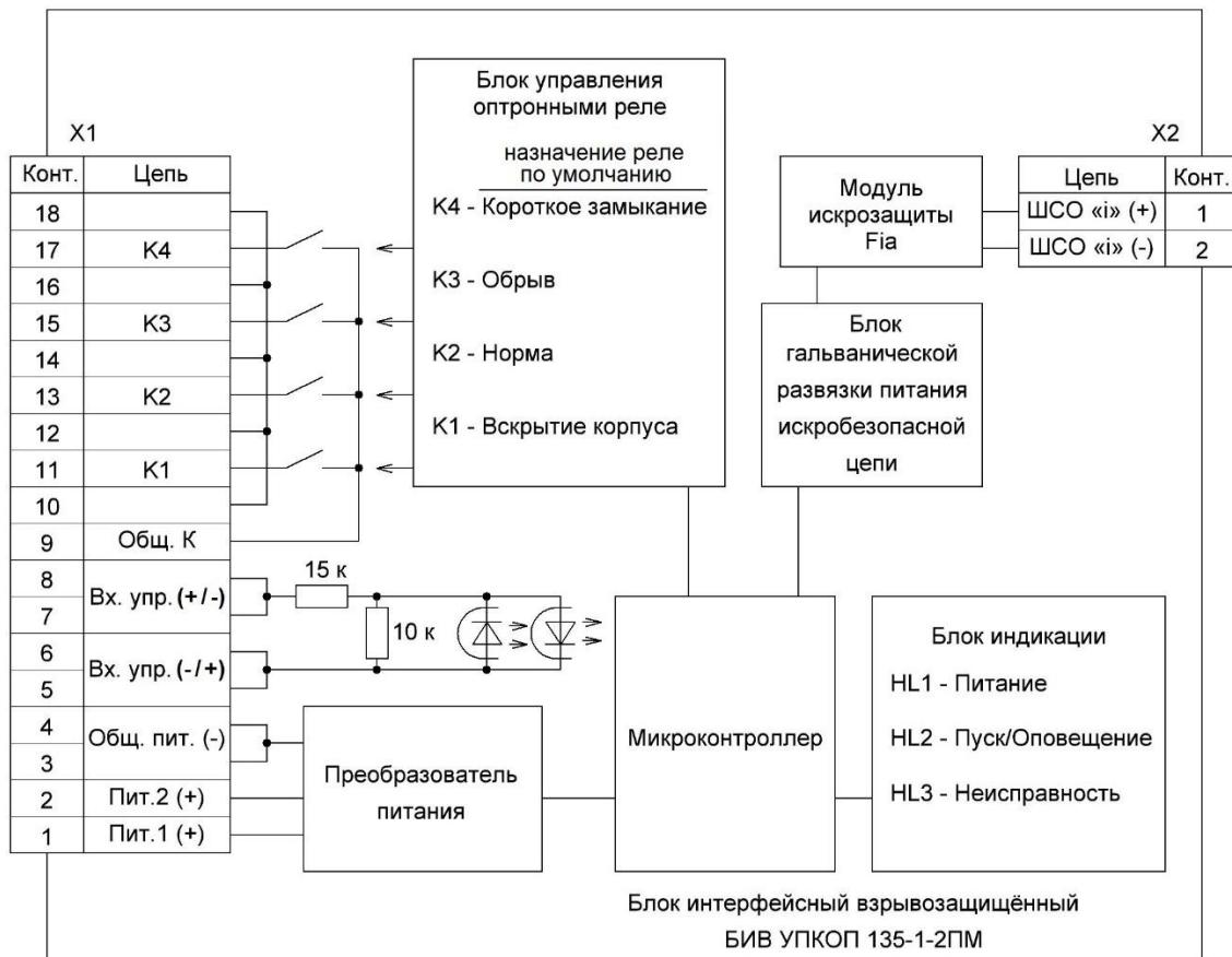
**ПРИЛОЖЕНИЕ В****Схема электрическая подключений УПКОП 135-1-2ПМ**
