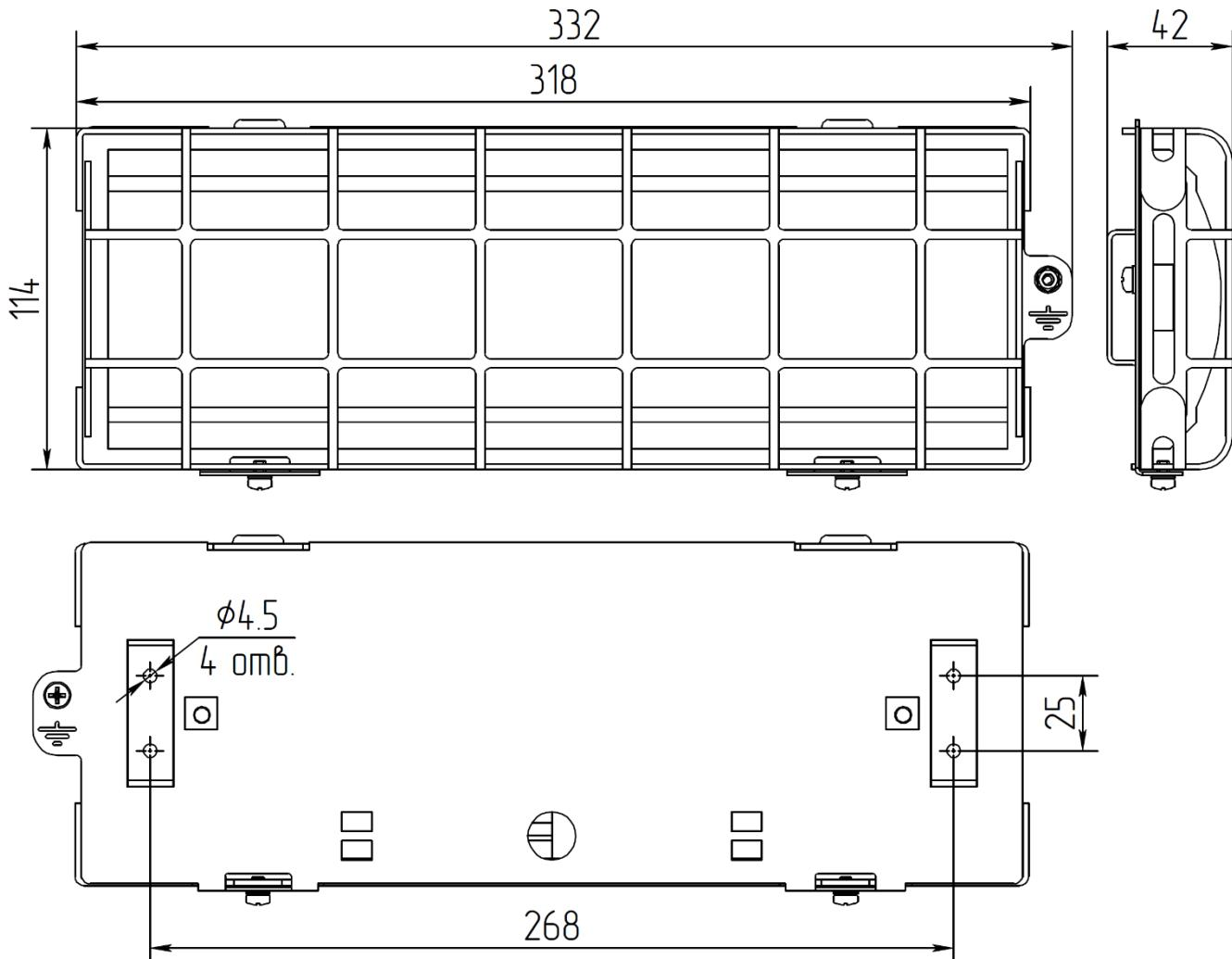
**Габаритные и установочные размеры оповещателя светового ОС**
