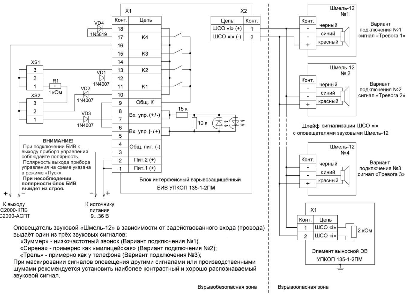
Оповещатель звуковой «Шмель-12» в зависимости от задействованного входа (проводка) выдаёт один из трёх звуковых сигналов:
