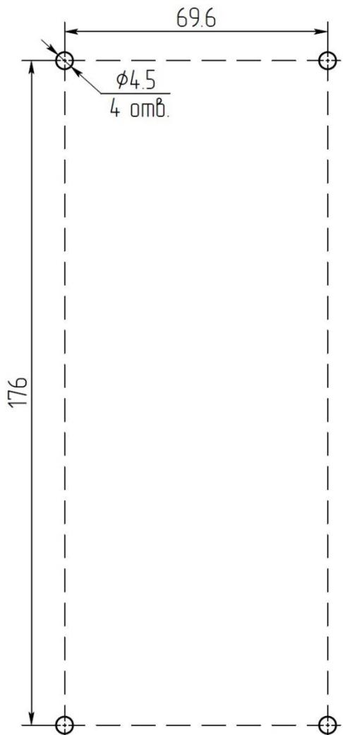
**Габаритные и установочные размеры выносного элемента ЭВ**
