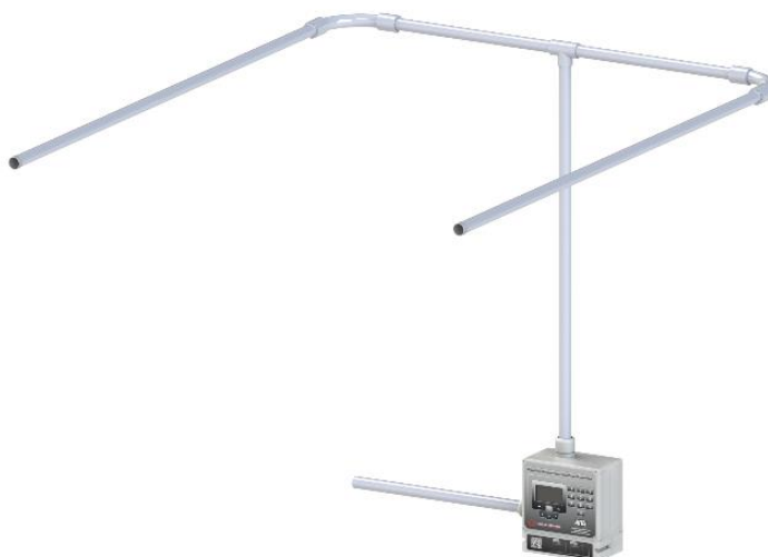
Рисунок 4 – Воздухозаборный трубопровод с 2 симметричными ветвями
