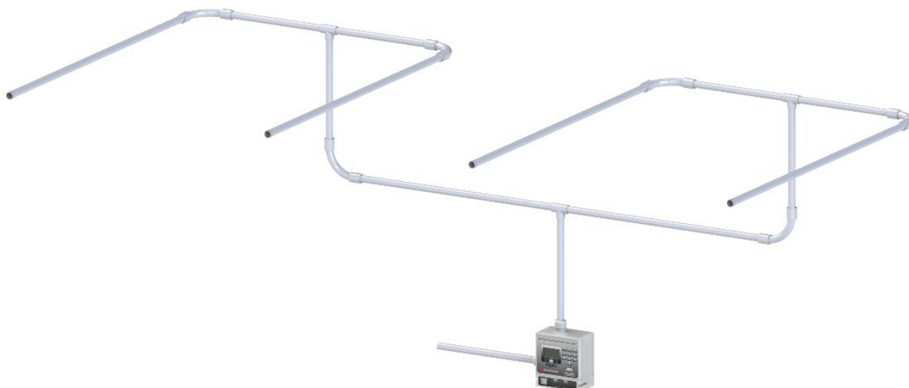
Рисунок 5 – Воздухозаборный трубопровод с 4 симметричными ветвями
