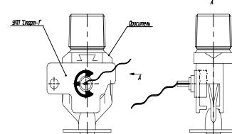
Рисунок 1 - Схема установки УПП «Старт-1» (исполнение 1) на оросители «СВВ», «СВН», «СВВ», «СВУ», «SSU», «SSP», «СВГ», «Бриз», «Бриз-Вертикаль», «Бриз-Горизонт», «Бриз-С-30/К45», «Бриз-С-20/К16», «Бриз-Г-20/К16».
