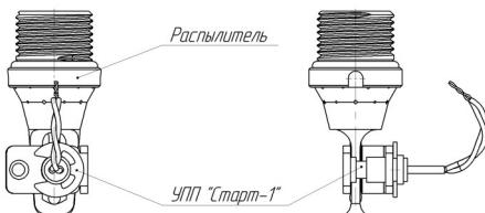
Рисунок 3 - Схема установки УПП «Старт-1»
