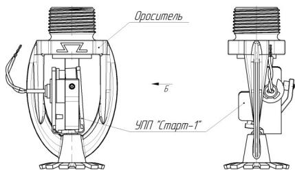
Рисунок 2 - Схема установки УПП «Старт-1»
