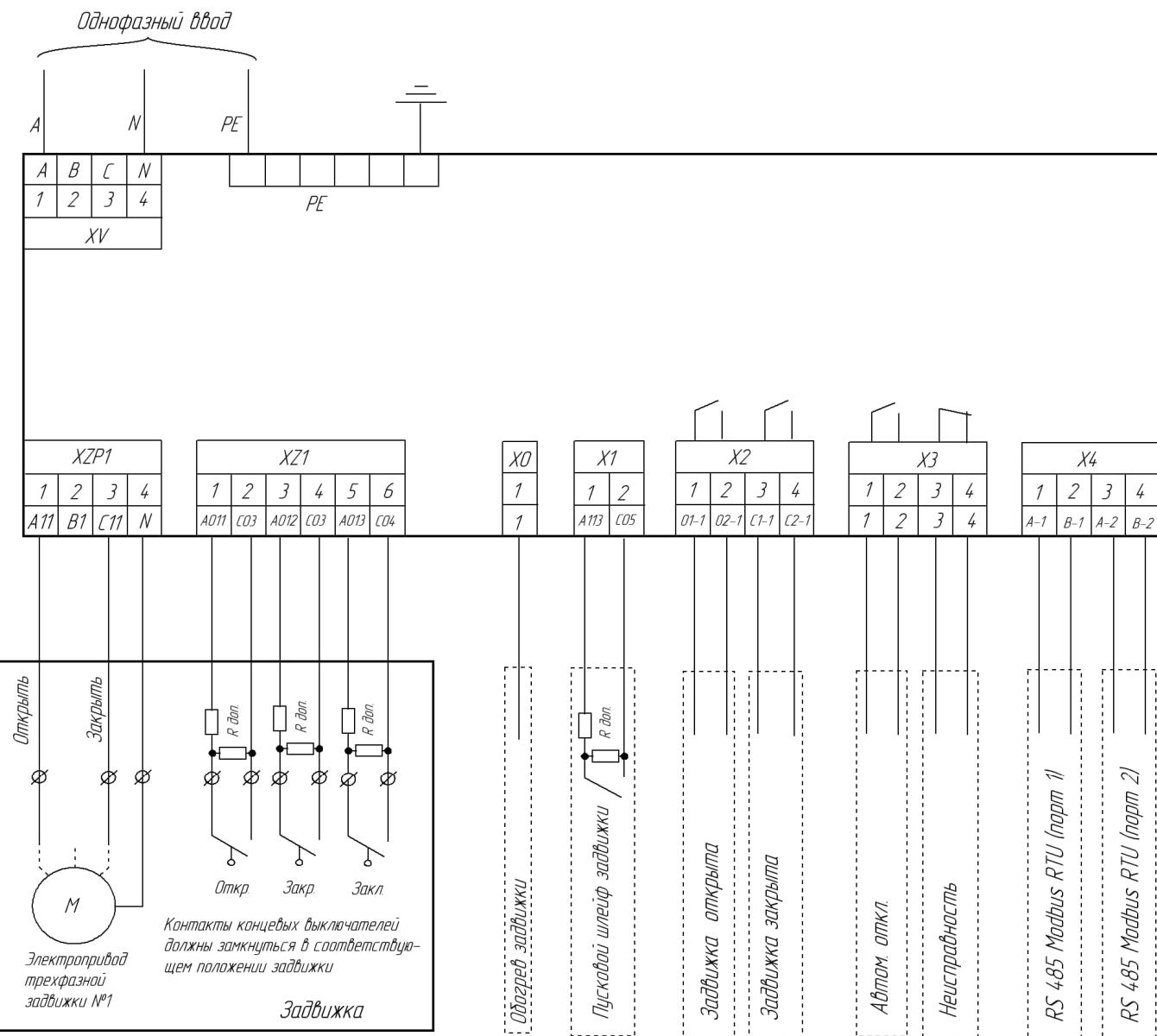
При подключении затвора дискового с электромеханическим приводом АН произвдстбо ЗАО "ПО "Спецавтоматика" нужно удалить в затворе перемычки с контактами 2-5 и 3-6.
