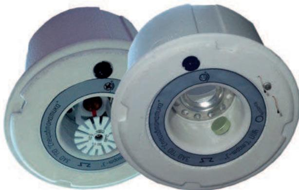
команду "Пуск". Происходит мгновенное разрушение термомембраны спринклера. Использование многофакторного контроля пожарной среды повышает объективность обнаружения пожара и уменьшает время его обнаружения. В случае необходимости предусмотрена возможность блокировки пуска и дистанционного пуска. Устройство в автоматическом режиме контролирует исправность батареи питания, цепи запуска и сенсоров. Монтаж устройства выполняется совместно с монтажом оросителя.
