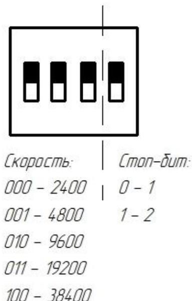
Рисунок 2 – Схема установки режимов работы ИКЗ
