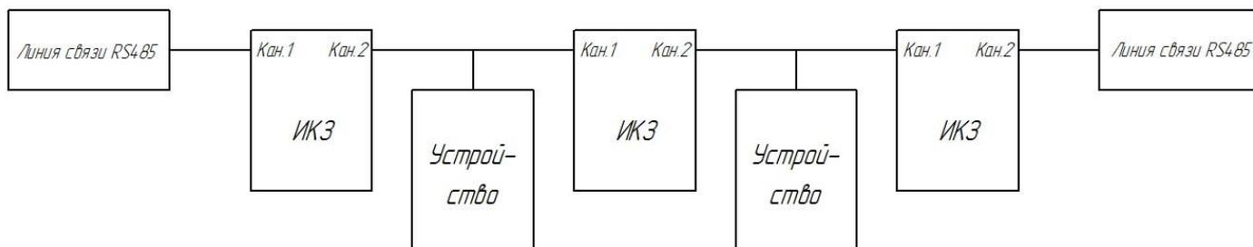
Для изоляции обособленного (не оконечного) участка линии связи (прибора, или группы приборов) требуется два ИКЗ. Возможно использование изоляторов как в линейной топологии линии связи, так и в кольцевой.
