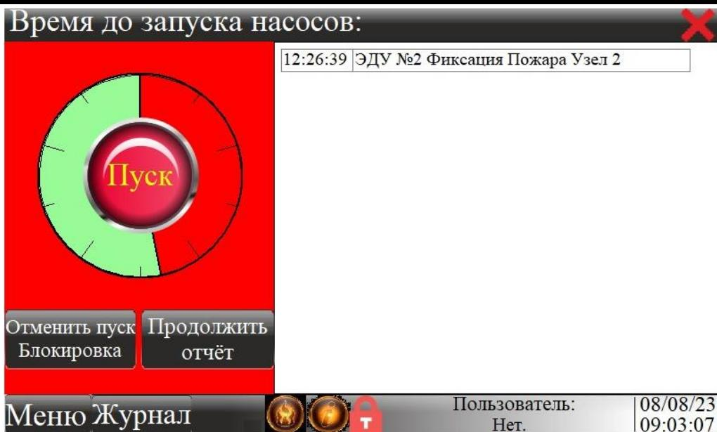
Рисунок 5 – Окно пуска после приостановки таймера
