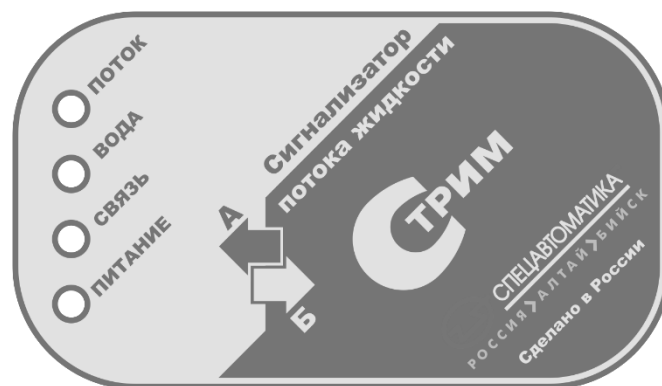
Рисунок 3 – Изображение индикаторов на крышке сигнализатора
