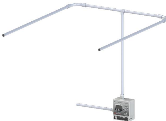
Рисунок 4 – Воздухозаборный трубопровод с 2 симметричными ветвями
