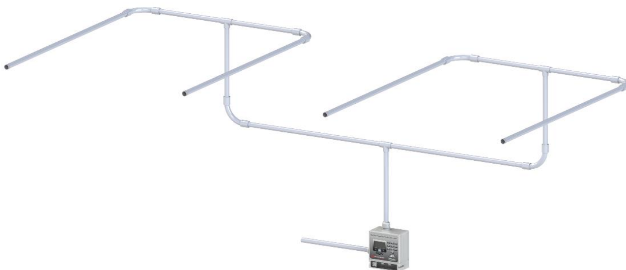
Рисунок 5 – Воздухозаборный трубопровод с 4 симметричными ветвями
