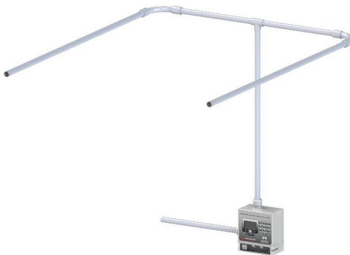
Рисунок 4 – Воздухозаборный трубопровод с 2 симметричными ветвями
