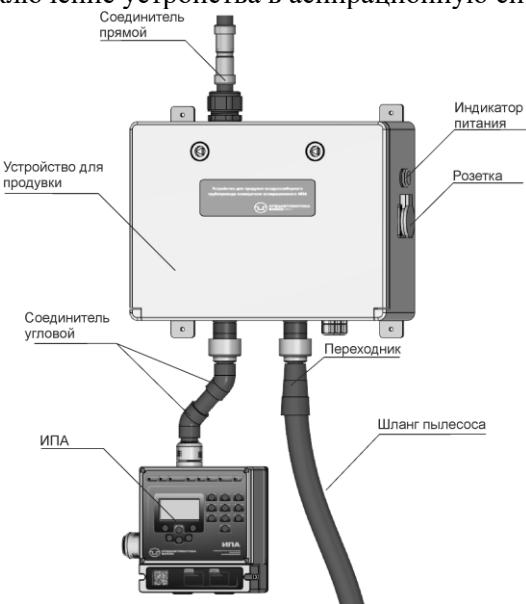
Электрическая схема подключений
