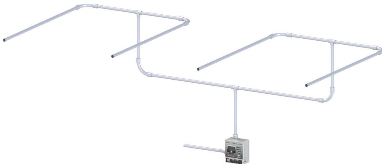
Рисунок 5 – Воздухозаборный трубопровод с 4 симметричными ветвями
