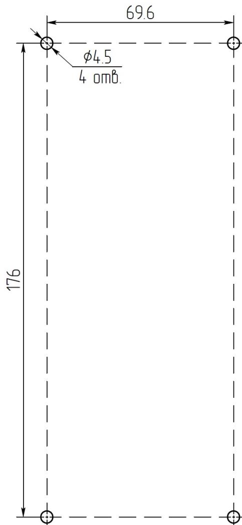
**Габаритные и установочные размеры выносного элемента ЭВ**
