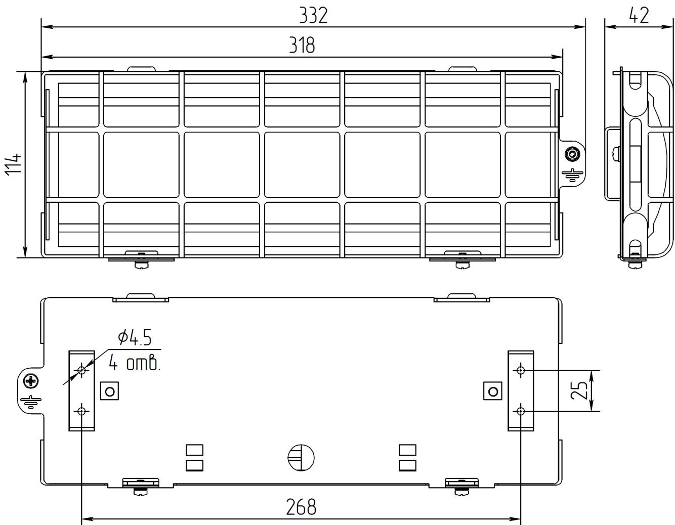
**Габаритные и установочные размеры оповещателя светового ОС**
