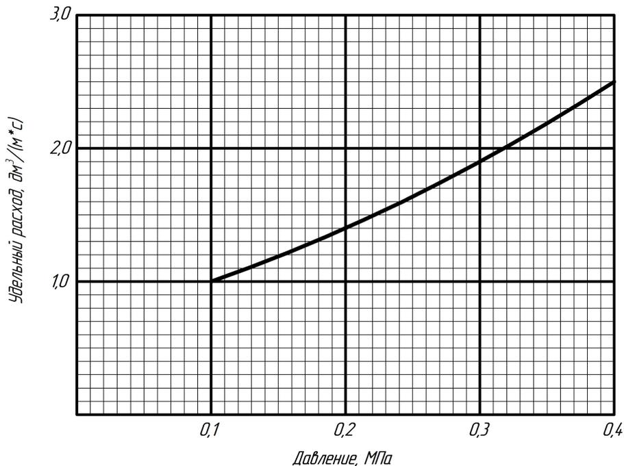
Рисунок 3 – Эпюра зависимости удельного расхода от давления
