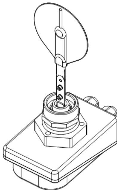
Рисунок 11 – Сигнализатор с футоркой и установленной лопаткой №2
