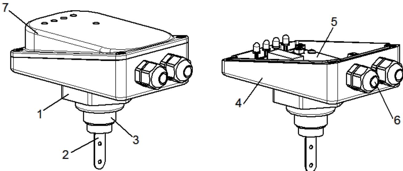
1 – корпус-шестигранник; 2 – чувствительный элемент; 3 – присоединительная муфта с трубной резьбой G3/4; 4 – основание корпуса; 5 – электронный модуль; 6 – герметичный кабельный ввод; 7 – крышка.
