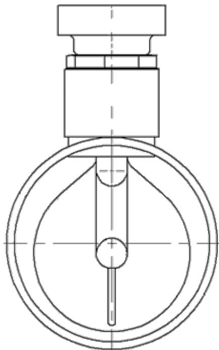
Рисунок 12 – Положение чувствительного элемента с лопаткой №2 относительно трубопровода
