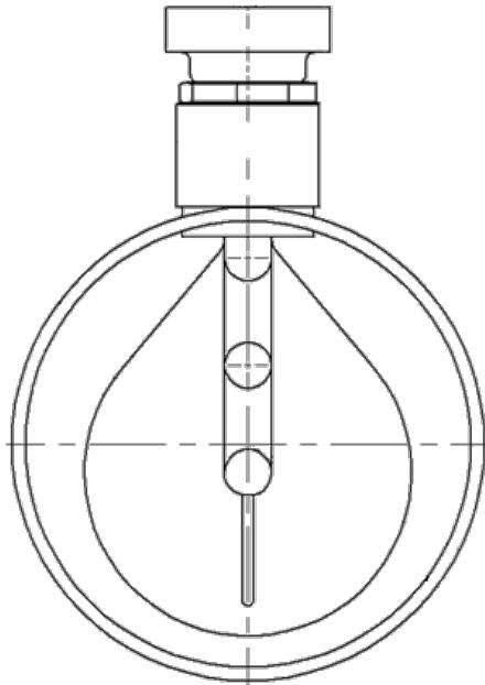
Рисунок 14 – Положение чувствительного элемента с лопаткой №3 относительно трубопровода
