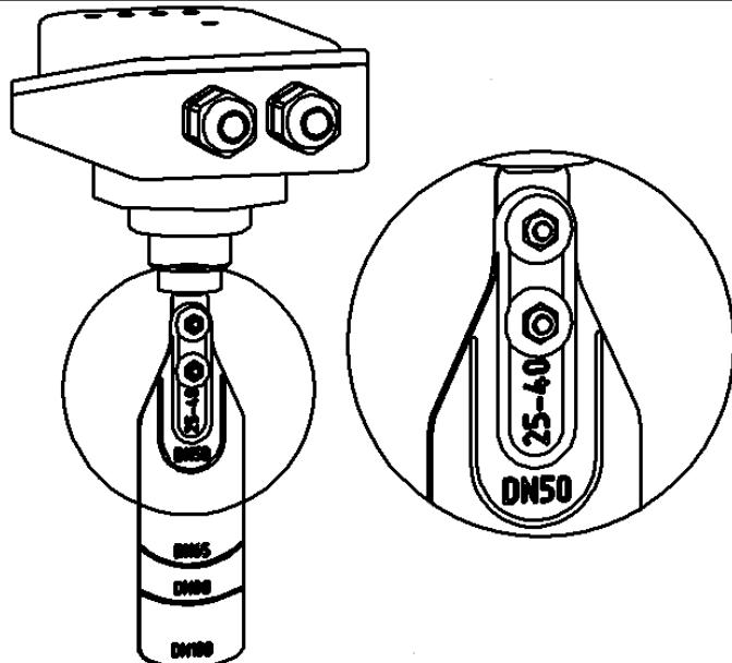
Рисунок 8 – Сигнализатор с установленной лопаткой №1
