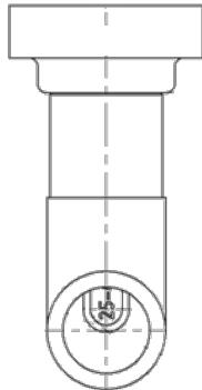
Рисунок 5 – Положение чувствительного элемента относительно трубопровода
