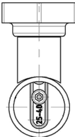
Рисунок 7 – Положение чувствительного элемента относительно трубопровода
