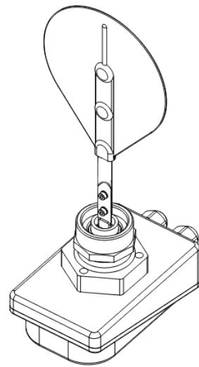
Рисунок 13 – Сигнализатор с футеркой и установленной лопаткой №3
